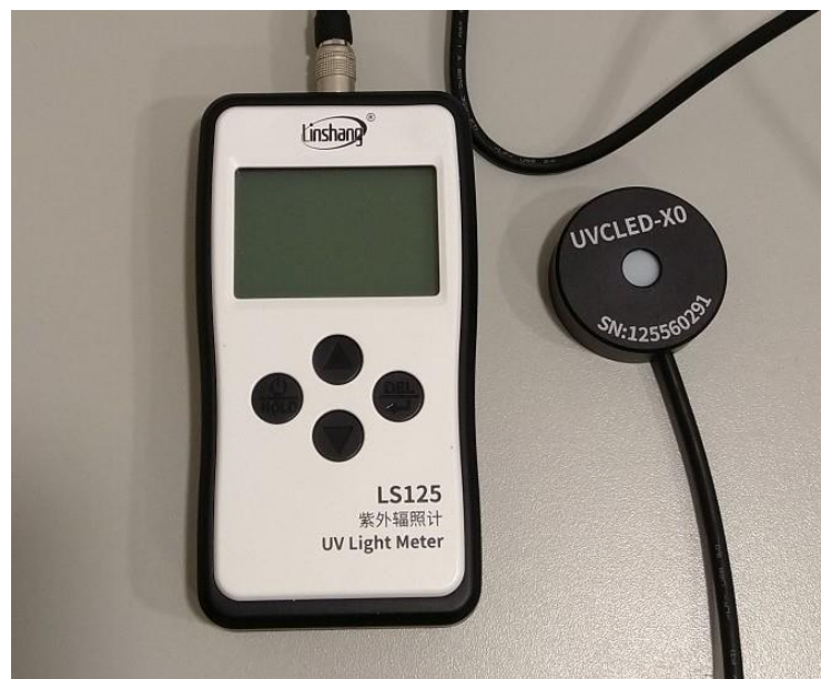
Abbildung 1: verwendetes UV-C-Messgerät mit Sensor UVCLED-X0 Figure 1: UV-C measuring device used with sensor UVCLED-X0
